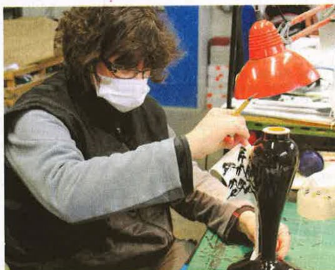
Au service parachèvement, les motifs des lampes sont dessinés à la main grâce à la technique du sablage.
